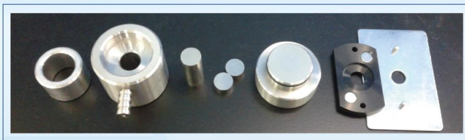
1. 压圈 2. 上横 3. 顶杆 4. 压舌(2个) 5. 下横 6. 磁性样品台
