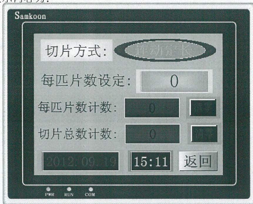
进入该画面后可进行每批片数设定：用手触摸一下“每批片数设定”设值按钮 **####.##**，触摸屏上显示浮动数字键盘。选择触摸数值键将每批片数设定设为要求值。
