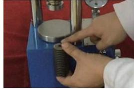
【9】压片机压把20摇动无力，压力表不上压，螺钉26松开，用手堵住低压阀口，摇动压把20，油会从26处流出，手堵不住阀口的油冒出时候，将螺钉26还原紧死。
