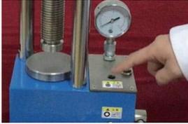
【2】加压时候注意，丝杠的螺纹必须全部进入上板，不能只连接几扣。防止丝杠螺纹变形。
