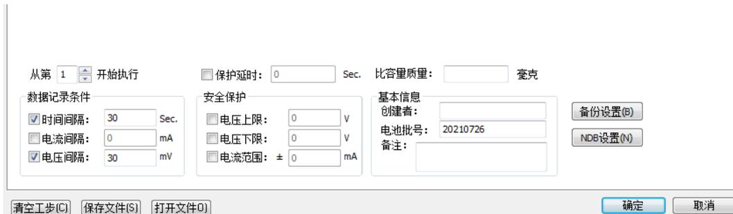
(2) 禁止勾选时间/电流/电压间隔而不填数字，会造成软件以最快速度记录数据而文件过大。
